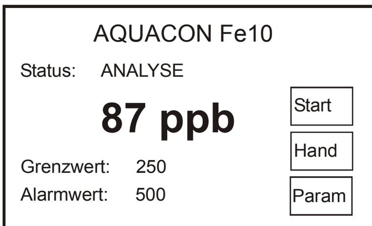
In der Messwertanzeige auf der Touchscreen wird der letzte Analysenwert, der eingestellte Grenzwert und der eingestellte Alarmwert angezeigt. Vom Benutzer kann der Grenzwert, der Alarmwert und die Pausenzeit zwischen zwei Analysen eingestellt werden (siehe 3.6).
